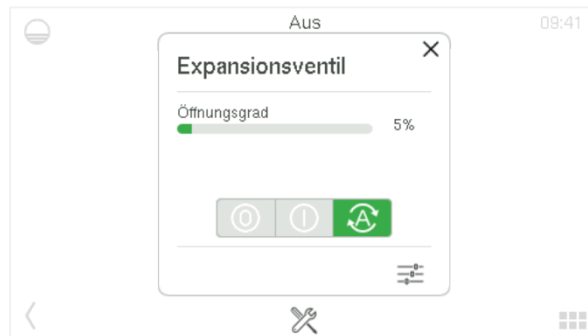
Expansionsventil im Automatikbetrieb
