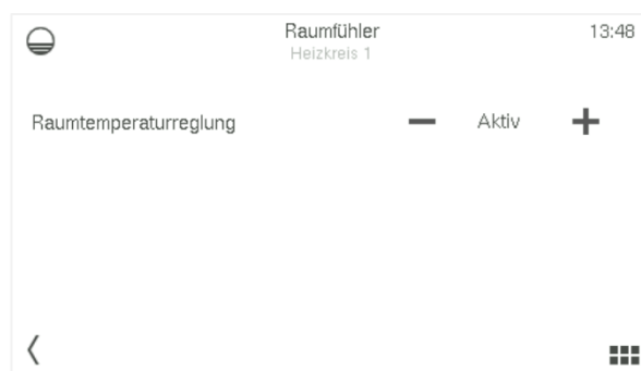
Aktivierung der Regelung nach der Raumtemperatur
