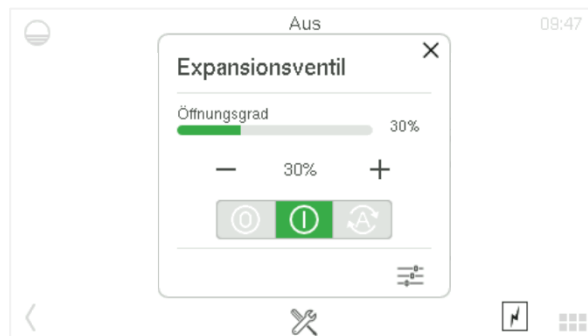
Manueller Öffnungsgrad des Expansionsventils
