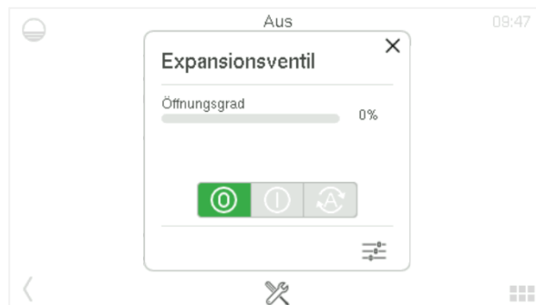
Expansionsventil manuell geschlossen
