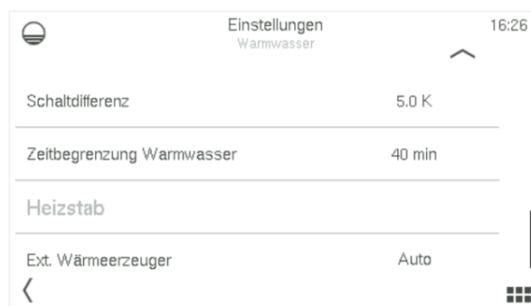
Aktivierung des Ext.-Wärmeerzeugers
